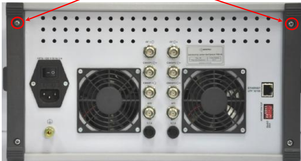
Рисунок 2– Схема пломбировки от несанкционированного доступа
