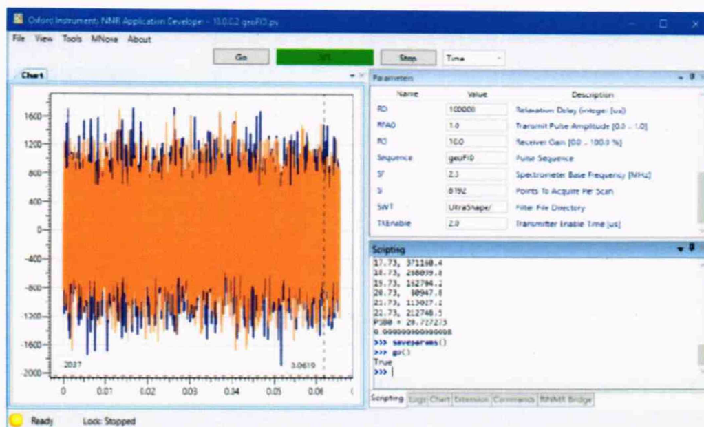
Рисунок 5. Сигнал пустого датчика при отсутствии значимых загрязнений
