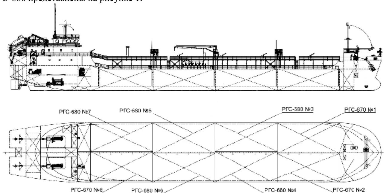
Рисунок 1 – Эскиз общего вида резервуаров РГС-670, РГС-680
