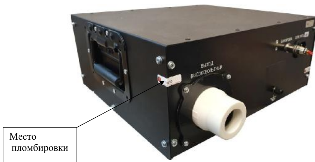
Рисунок 3 – Схема пломбировки установок от несанкционированного доступа
