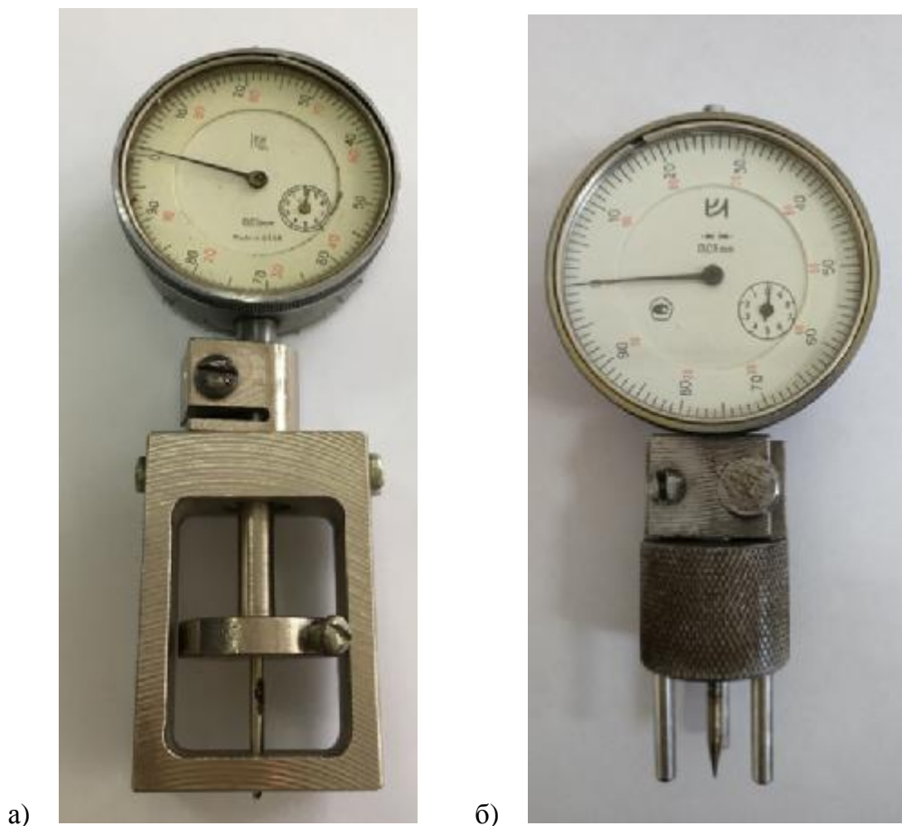
Рисунок 1 – Общий вид глубиномеров а) исполнение ОГТ-301-П-257.000, б) исполнение 934.8512-0041
