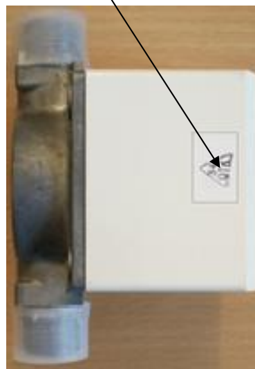
Рисунок 3 – Схема пломбировки от несанкционированного доступа, обозначение места нанесения знака поверки счетчиков СГ-1 вариант 12 серии 05, 06, 07
