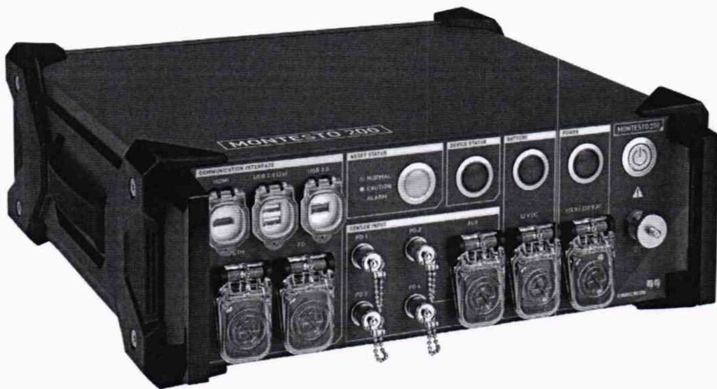
Рисунок 5 – Общий вид основного блока системы MONTESTO 200
