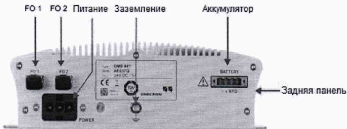
Рисунок 9 – Задняя панель устройства OMS 841
