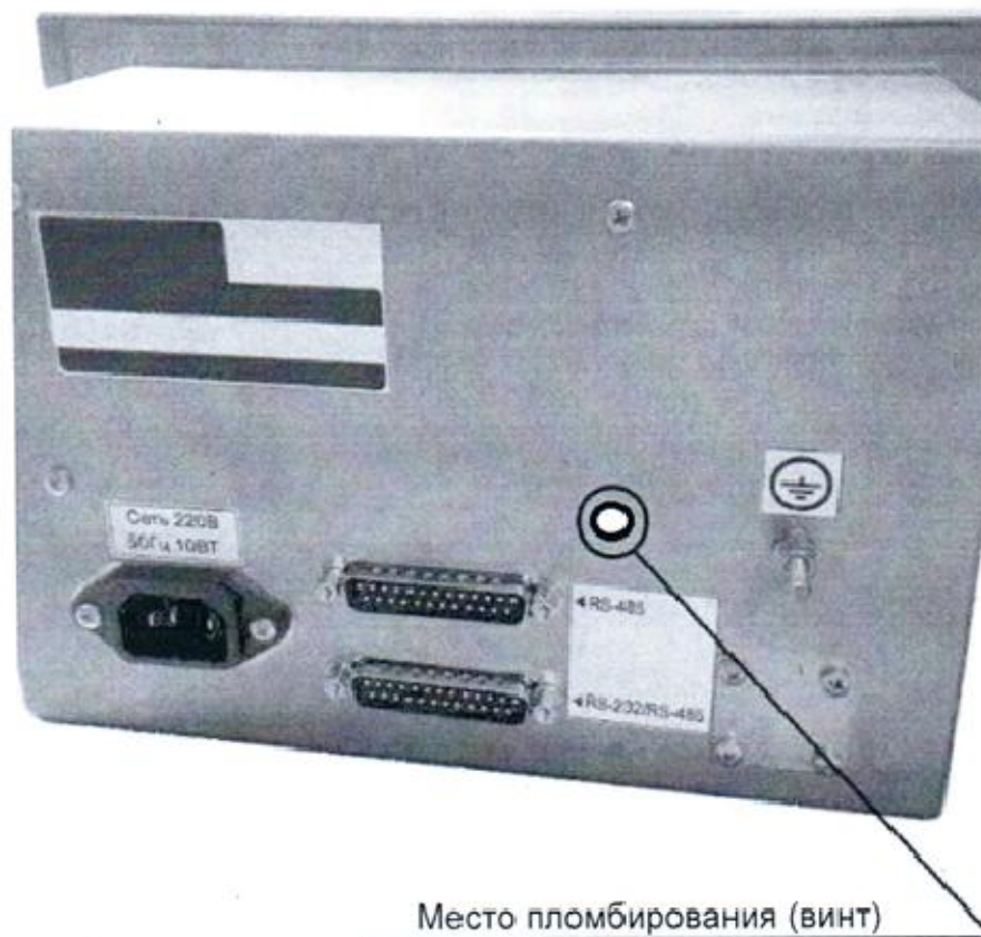
Рисунок 6 – Схема пломбировки индикатора ТЦ017
