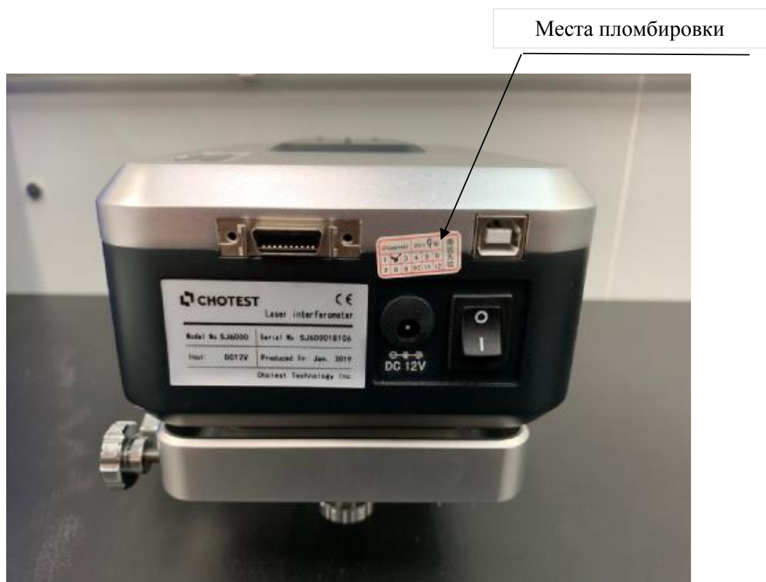
Рисунок 2 – Схема пломбировки систем
