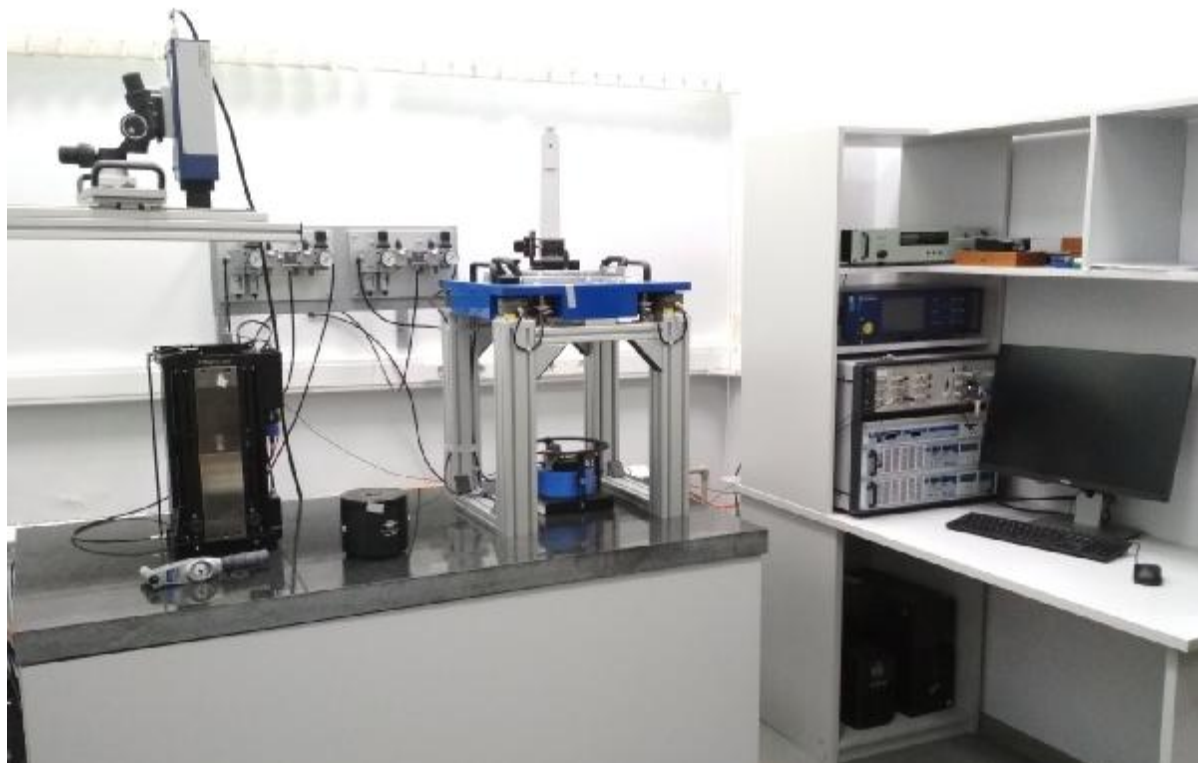
Рисунок 1 – Общий вид установки для поверки и калибровки виброизмерительных преобразователей CS18P VLF HF
