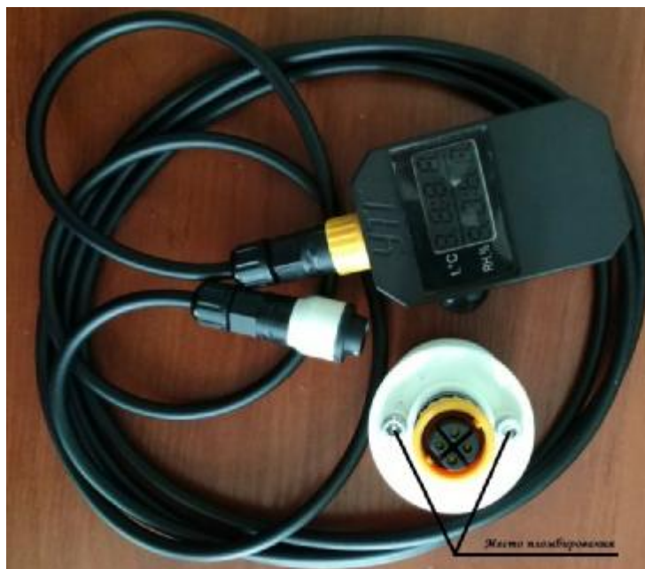
Рисунок 2 – Схема пломбирования термогигрометров «УТГ»
