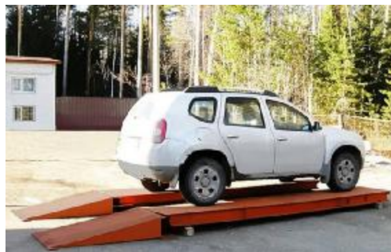
ГПУ из не совмещённых секций
