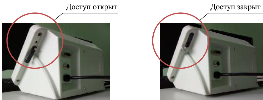
Рисунок 3 — Схема пломбировки от несанкционированного доступа КСК18
