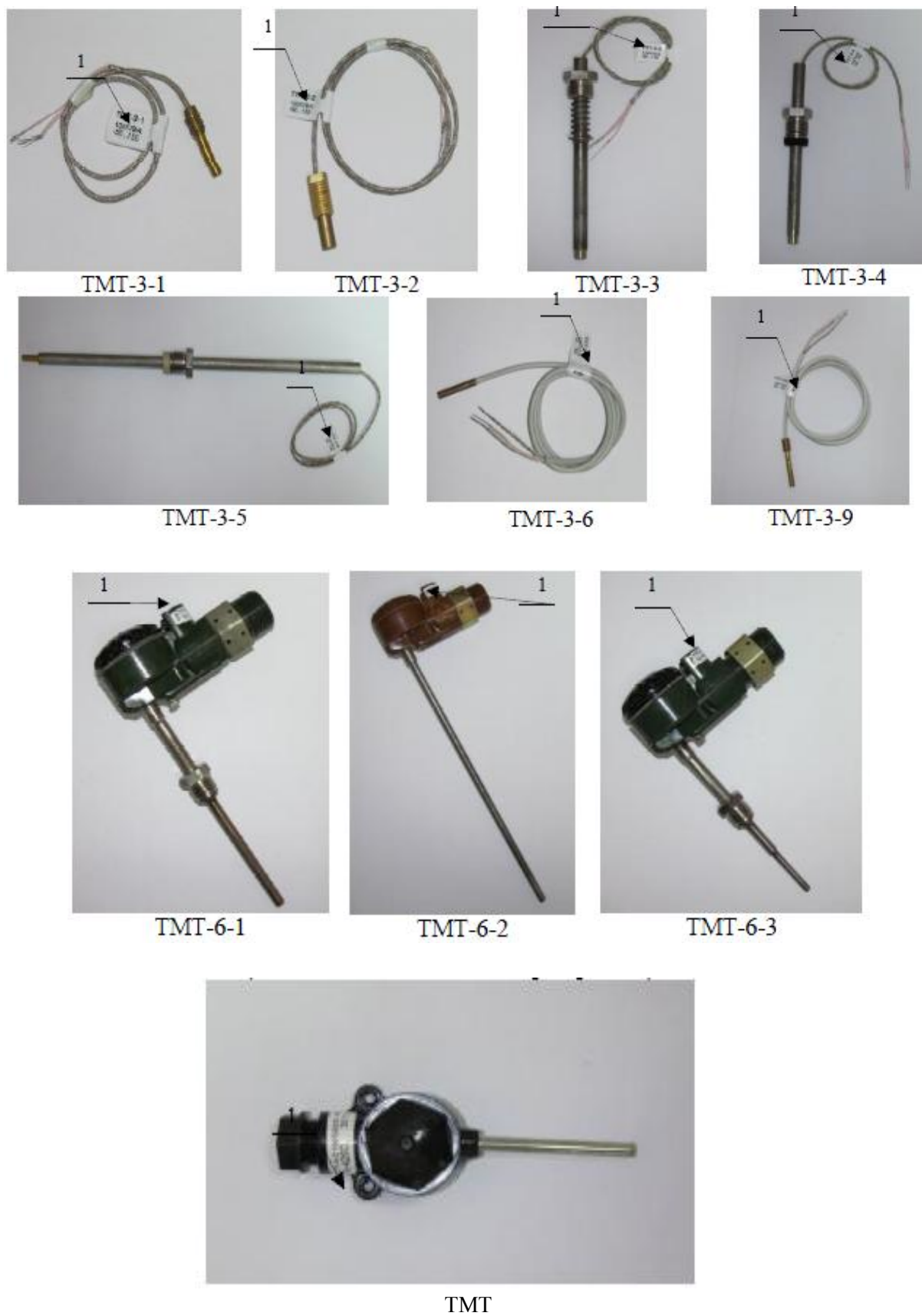
Рисунок 1 – Общий вид и тип преобразователей температуры, входящих в состав устройства
