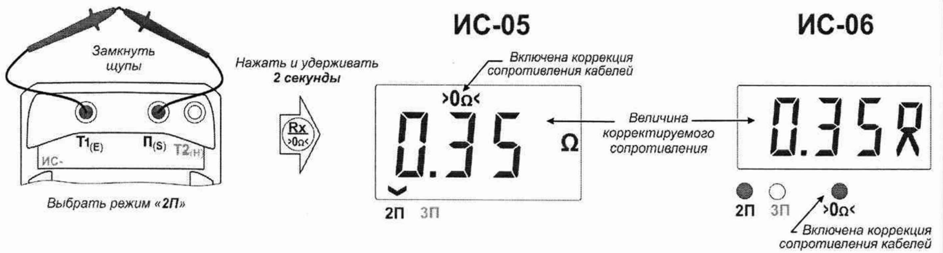
Рисунок 4 – Коррекция сопротивления измерительных кабелей (2П)
