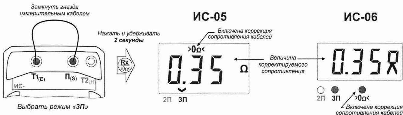
Рисунок 3 – Коррекция сопротивления измерительного кабеля (3П)
