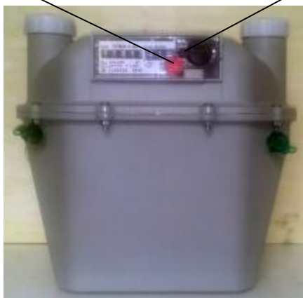
Рисунок 2 – Схема опломбирования счетчика, обозначение мест нанесения знака поверки
