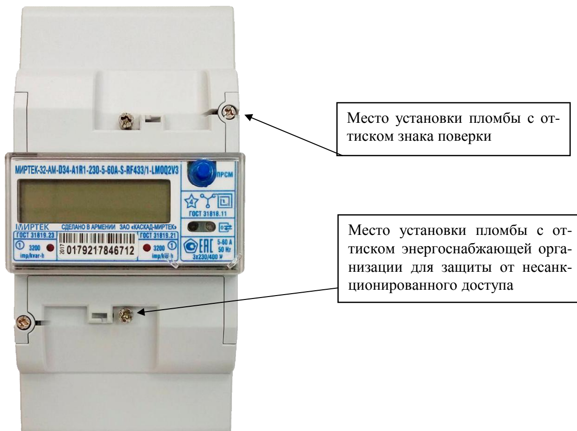
Рисунок 6 – Общий вид счетчика и схема пломбировки от несанкционированного доступа в корпусе типа D34
