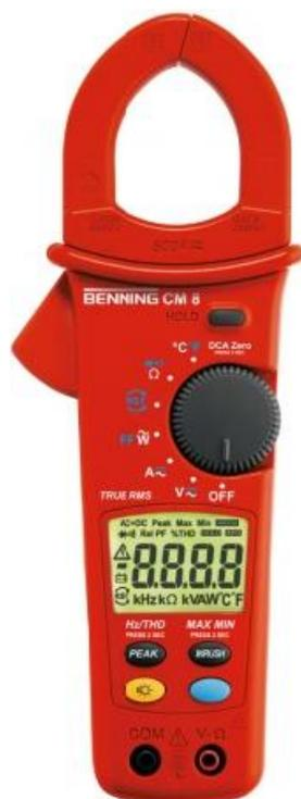
Рисунок 13 – Общий вид клещей токоизмерительных BENNING CM 8
