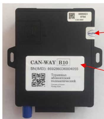
Рисунок 2 – Схемы нанесения знака утверждения типа и пломбировки от несанкционированного доступа
