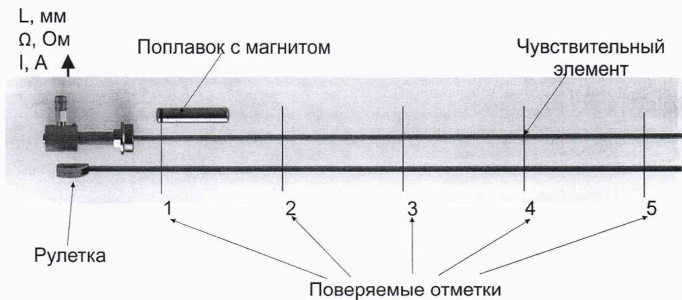
Рисунок 3 – Проверка уровнемера с помощью рулетки и магнитного поплавка
