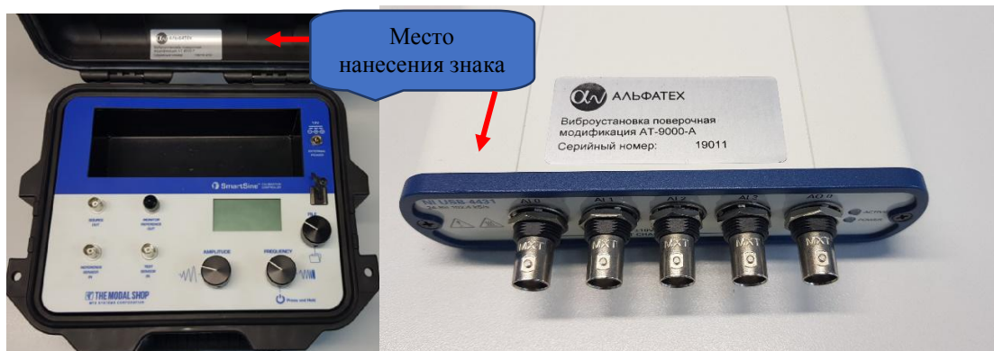
Рисунок 1 – Общий вид блока управления виброустановки поверочной модификации АТ-9000-Р (контроллера 9000А) и место нанесения знака поверки
