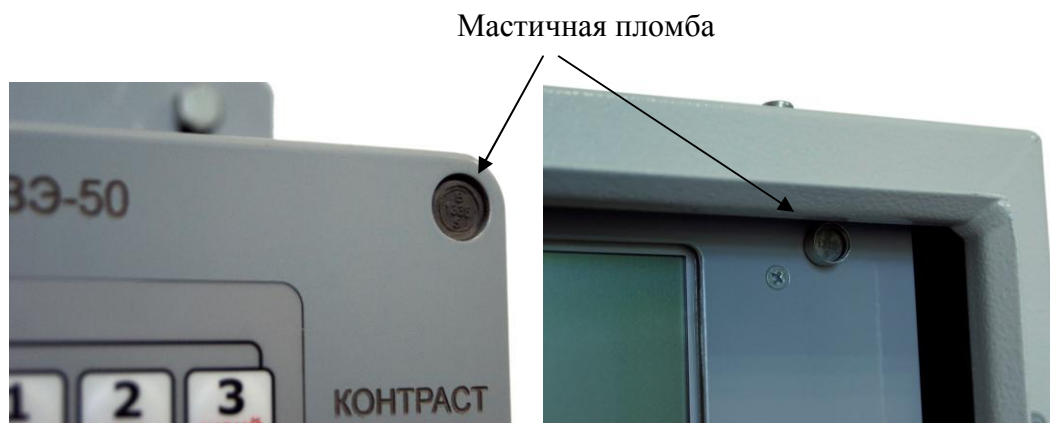
Рисунок 3 – Схема пломбировки прибора ИВЭ-50 от несанкционированного доступа
