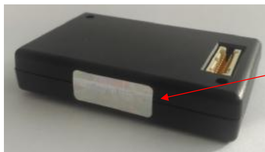
Рисунок 2 - Место пломбировки от несанкционированного доступа
