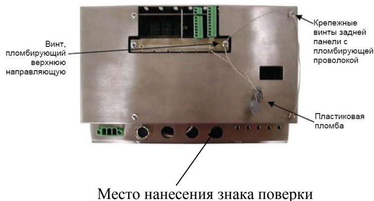
Рисунок 2 - Схема пломбировки терминала IND780 с обозначение места нанесения знака поверки
