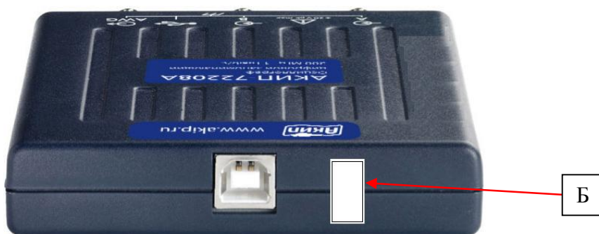
Рисунок 2 – Вид задней панели и схема пломбировки от несанкционированного доступа (Б)
