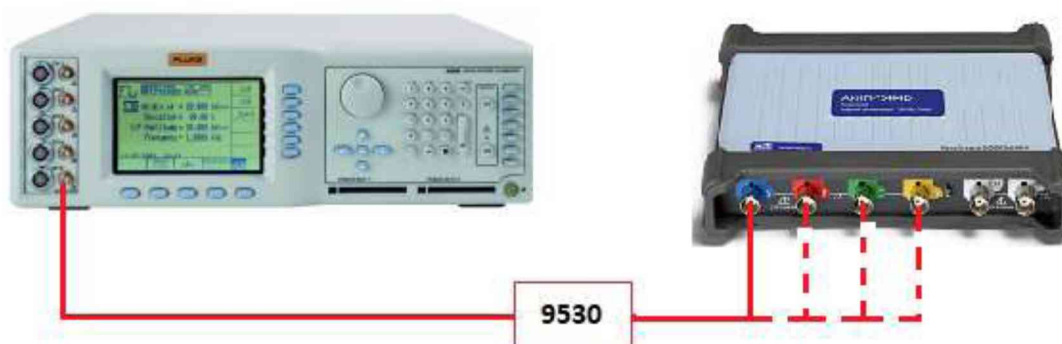
Рисунок 2 – Структурная схема соединения приборов для определения ширины полосы пропускания и времени нарастания переходной характеристики
