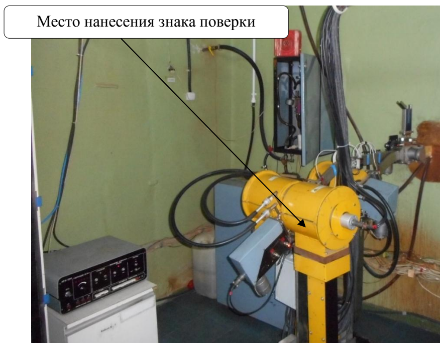
Рисунок 1 – Общий вид установки для определения кислорода К-7
