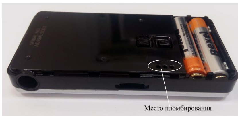
Рисунок 2 – Место для пломбирования узлов регулировки показаний анализаторов
