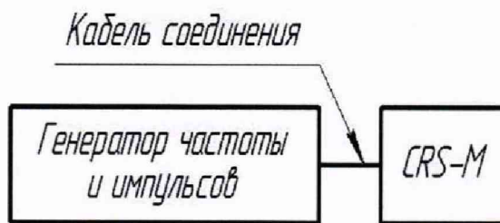
Рисунок 4 - Схема проверки системы по подсчёту количества импульсов
