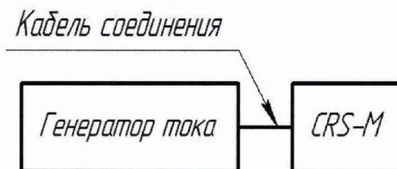
Рисунок 3 - Схема поверки системы по токовым входам
