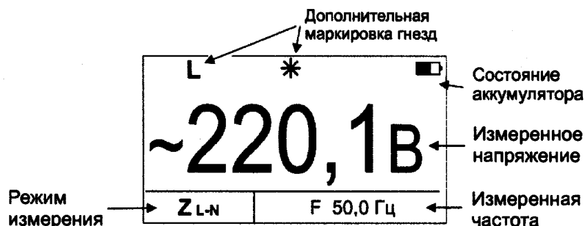
Рисунок 2.4. - Измерение напряжения и частоты
