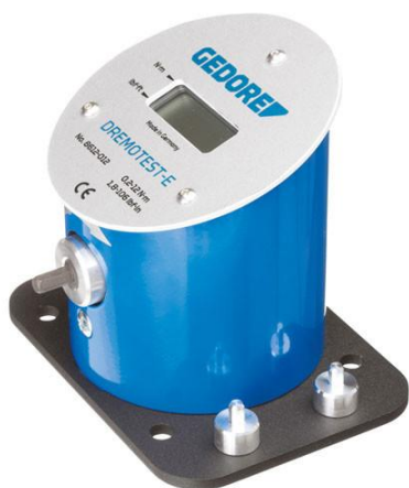
Рисунок 1 – Общий вид измерителей (моментомеров) крутящего момента силы DREMOTEST-E модификаций 8612-012, 8612-050, 8612-300, 8612-1000
