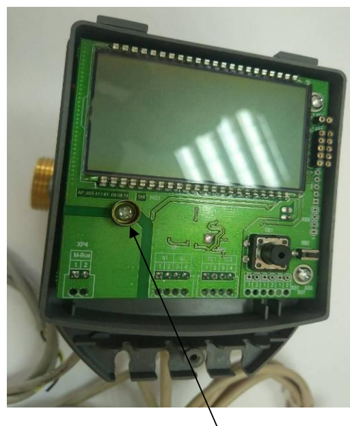
Рисунок 6 – Место нанесения знака поверки
