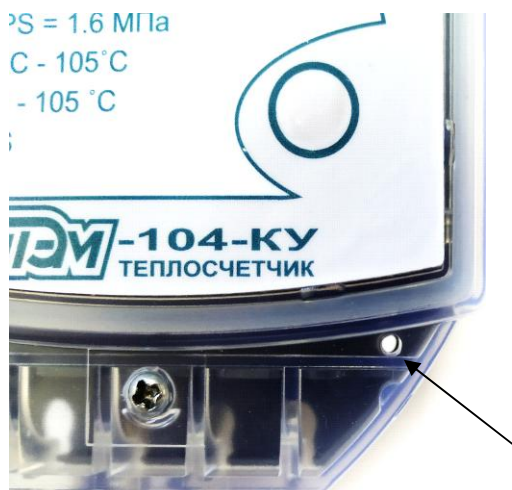
Рисунок 3 – Место пломбировки вычислителя
