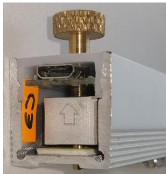
Рисунок 2 – Место пломбировки от несанкционированного доступа
