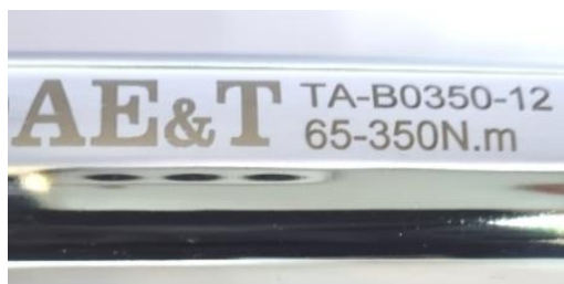
Рисунок 3 - Обозначения, наносимые на корпус ключей динамометрических предельных регулируемых ТА-В: а) торговый знак, модификация, диапазон воспроизведений; б) серийный номер.
