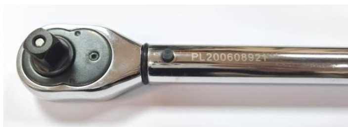
Рисунок 3 - Обозначения, наносимые на корпус ключей динамометрических предельных регулируемых ТА-В: а) торговый знак, модификация, диапазон воспроизведений; б) серийный номер.
