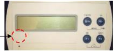
Пломбировка доступа к переключателю режимов настройки и юстировки на передней панели корпуса приборов модификаций WE2107, WE2108
