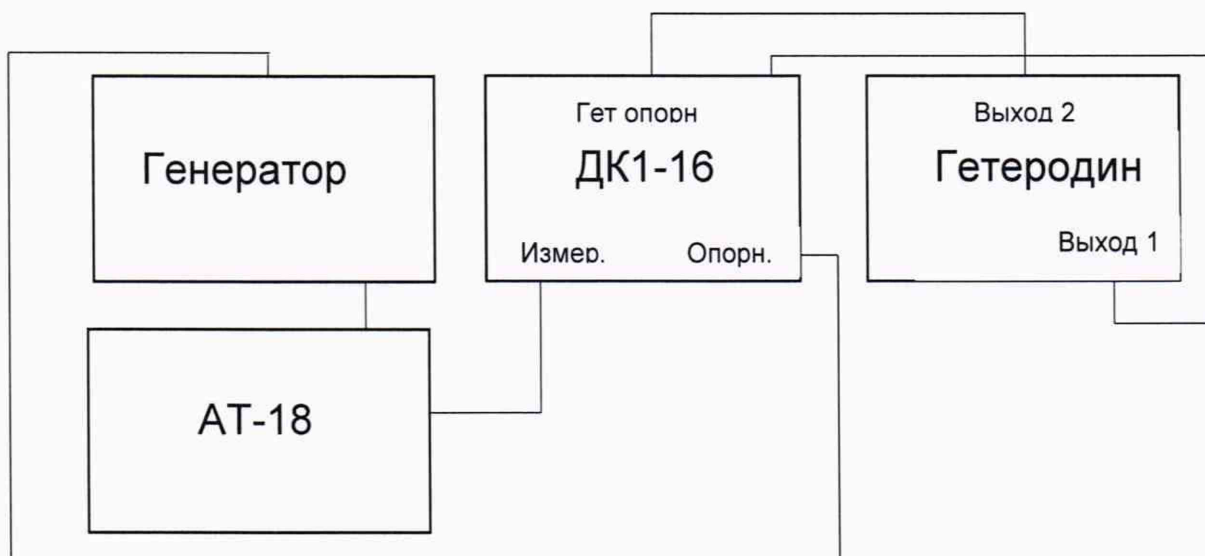
Рисунок 1 – Схема подключения для определения диапазона и абсолютной погрешности установки ослабления в диапазоне частот от 0 до 1,1 ГГц.
