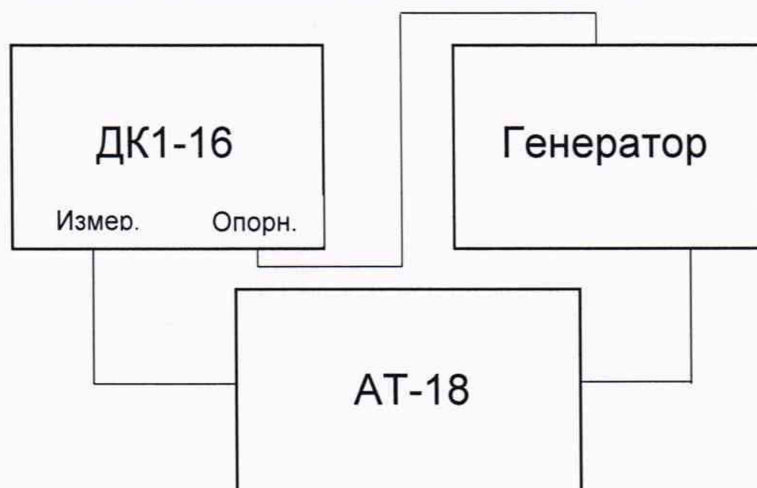
Рисунок 2 – Схема подключения для определения диапазона и абсолютной погрешности установки ослабления в диапазоне частот от 1,1 до 17,85 ГГц.
