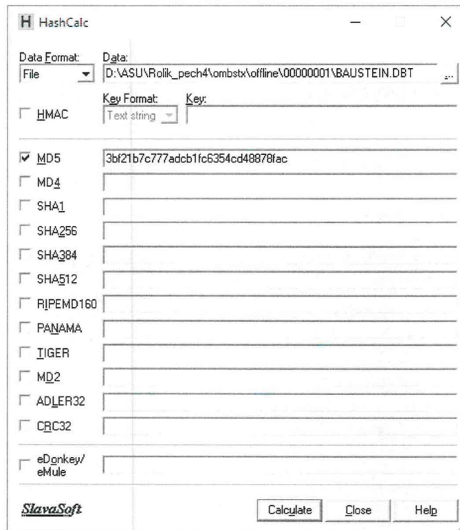
Рисунок 1 – Расчет контрольной суммы MD5 файла конфигурации проекта PLC
