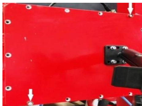
Рисунок 2 – Места пломбирования тележки (указаны стрелками)
