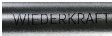
Рисунок 2 – Пример типовой маркировки ключей с нанесением товарного знака.
