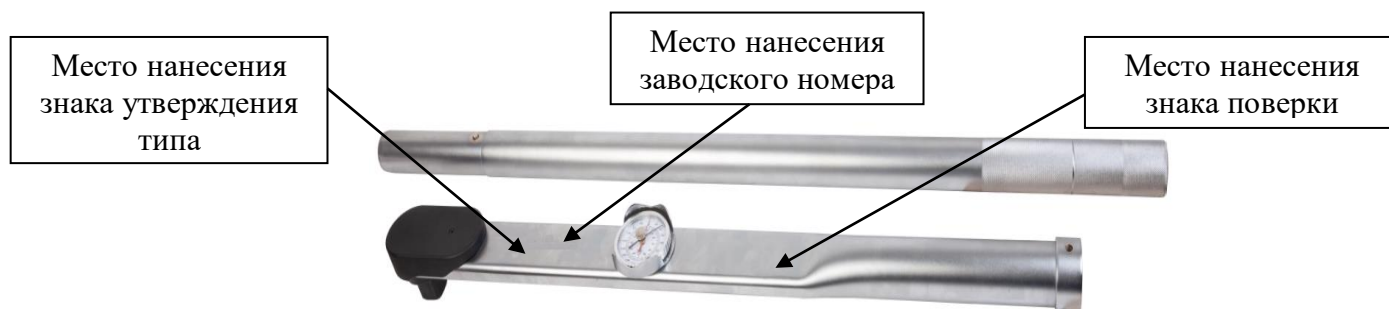
Рисунок 1 – Общий вид ключей с указанием мест нанесения знака утверждения типа, знака поверки, заводского номера
