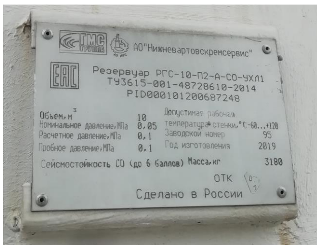
Рисунок 1 – Место нанесения заводского номера
