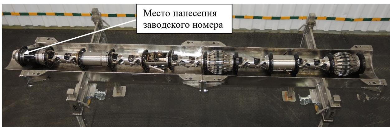
Рисунок 1 – Общий вид дефектоскопа внутритрубного магнитного 6-МСК.02-00.000-01
