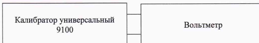
Рисунок 1 – Схема подключения для определения приведенной (к верхнему пределу диапазона измерений) погрешности измерений модификаций S5U□□□-□
