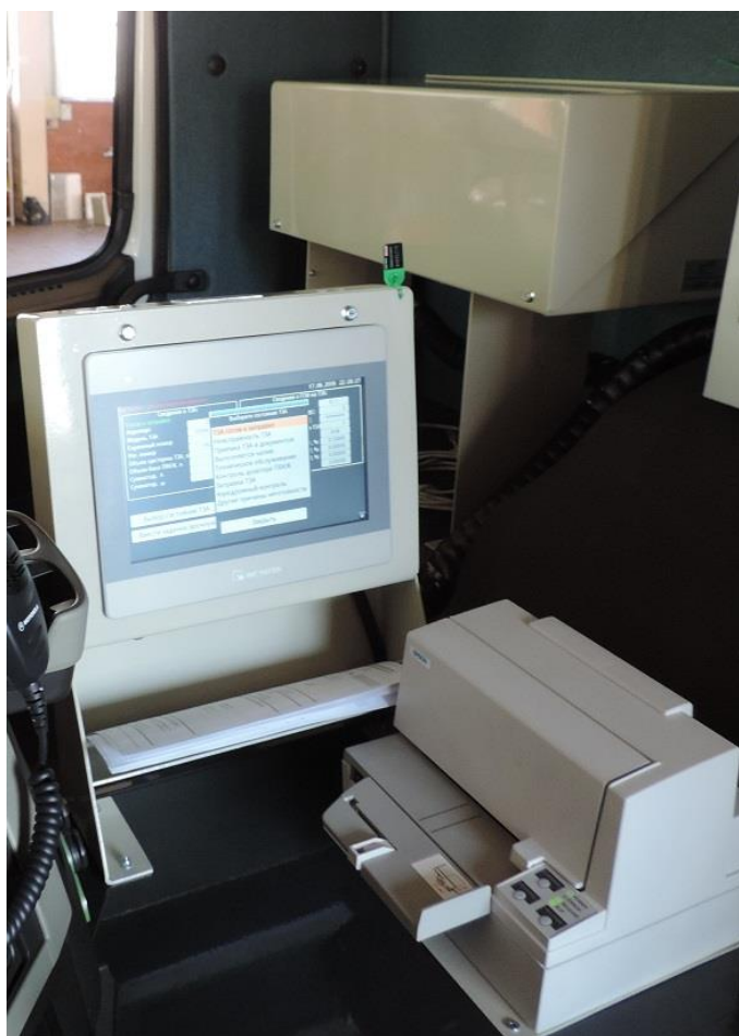
Рисунок 3 – Общий вид составных частей системы (БСК с закрытой защитной крышкой, ТОС-10, принтер) в кабине средства заправки
