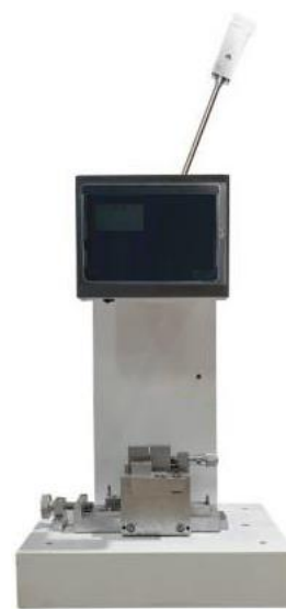
Рисунок 4 – Общий вид копров маятниковых модификаций ТМК-1 50А-Ц Tochline, ТМК-1 50А-К Tochline, ТМК-1 50Р-Ц Tochline, ТМК-1 50Р-К Tochline, ТМК-1 5.5А-Ц Tochline, ТМК-1 5.5А-К Tochline, ТМК-1 5.5Р-Ц Tochline, ТМК-1 5.5Р-К Tochline
