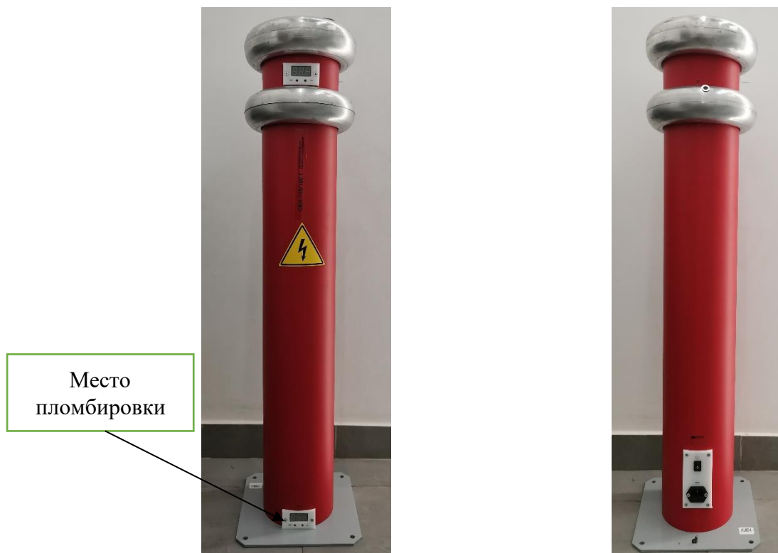
Рисунок 1 - Общий вид и обозначение мест пломбировки от несанкционированного доступа модификации СВИ-125/180Т
