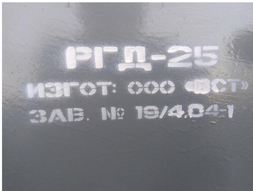
Рисунок 5- Фотография заводского номера резервуара стального горизонтального цилиндрического двустенного РГД-25 заводской номер 19/4.04-01
