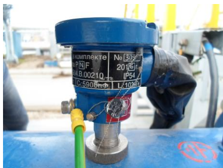
Рисунок 2 - Места установки пломб на ТПР
