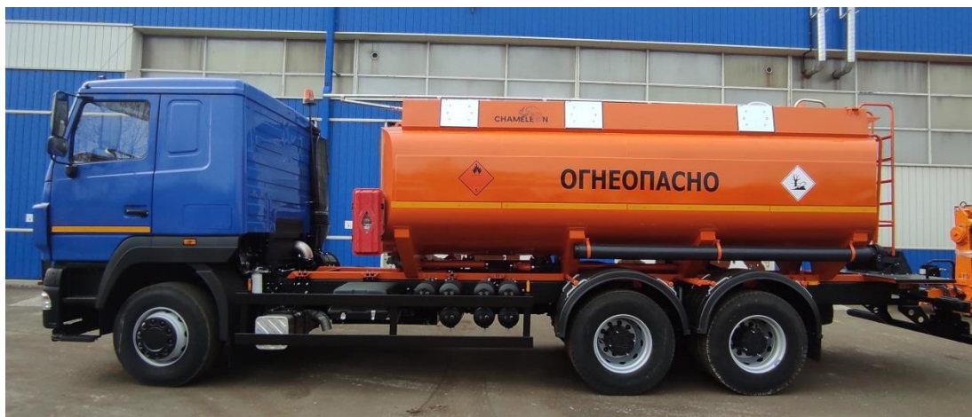
Рисунок 1 – Общий вид автоцистерны АЦ-17,0 4693D2
