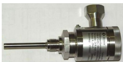
Рисунок 7 – Термопреобразователь корабельный ТПК-67
