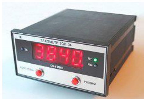
Рисунок 9 – Тахометр электронный цифровой ТСП-04, исп. 1
