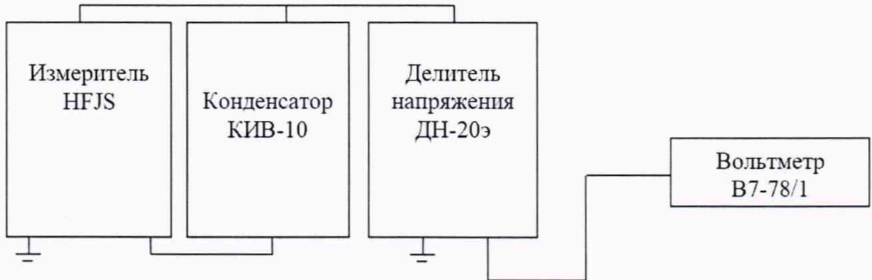
Рисунок 2 – Схема проверки абсолютной погрешности воспроизведений напряжения и частоты переменного тока
