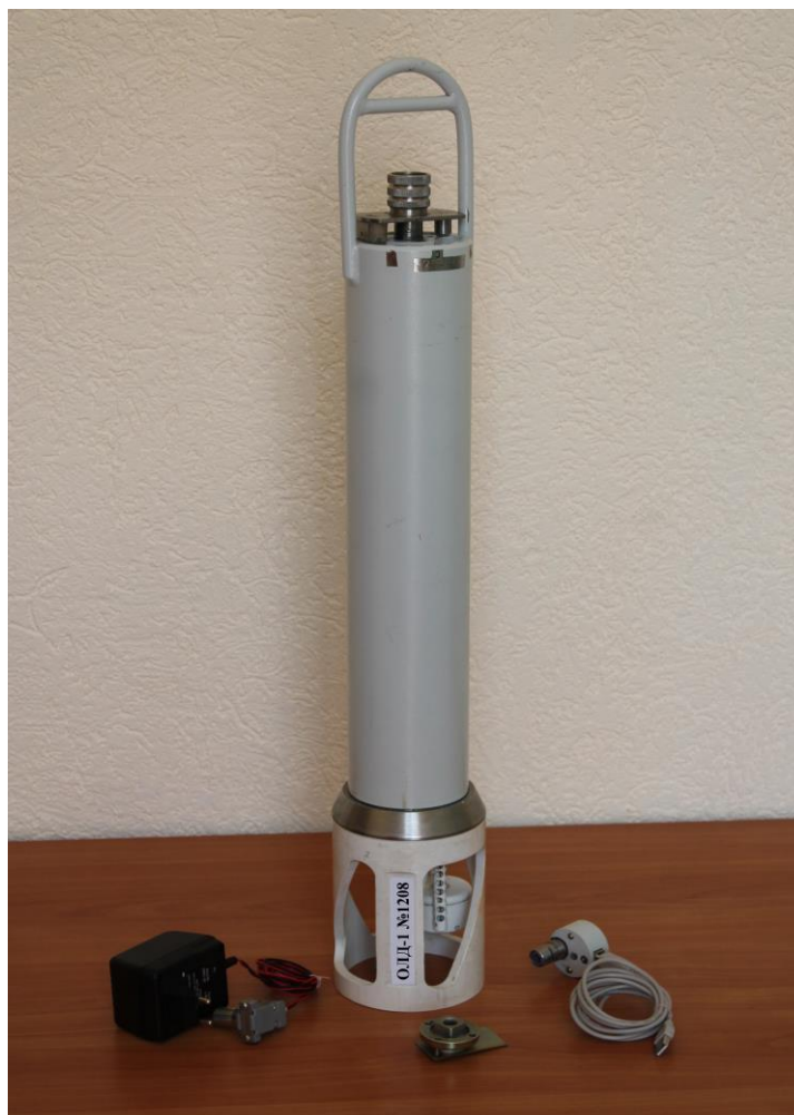
Рисунок 1 - Общий вид зондов гидрологических ОЛД-1
